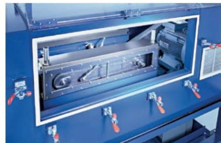
Zincir yıpranma uzaması davranışının test edilmesi 20'den fazla test platformunda yapılr
