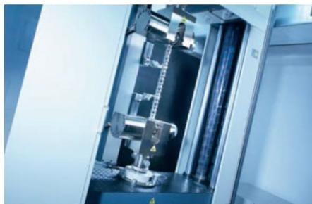
Zincir kopma dayanımının ve 1000 kN'ye kadar esnemenin değerlendirilmesi
