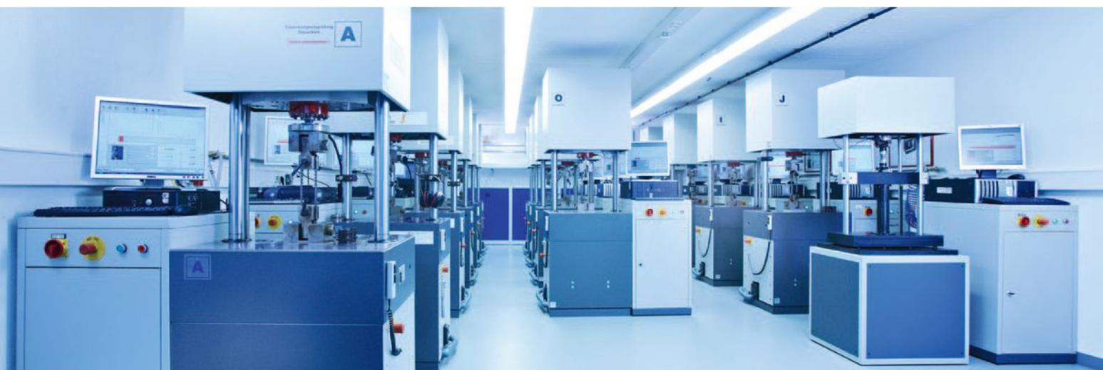
iwis verfügt mit mehr als 60 Entwicklungsingenieuren über die größte F&E-Abteilung für Kettentriebssysteme in Europa. Neben Grundlagenentwicklung und Entwicklung von innovativen kundenspezifischen Lösungen, sind Berechnungen über Konstruktion von Versuch bis hin zu Verschleiß und Dauerfestigkeitsuntersuchungen Hauptbestandteile der Entwicklungsabteilung bei iwis.
